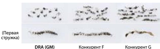
Режимы резания: Врез = 60 м/мин, f = 0,2 мм/об, диаметр сверления  $\phi 14$ , L/D = 5
