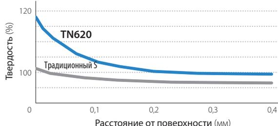
Сердцевина TN620 обладает высокой прочностью и сопротивлением выкрашиванию наряду с более высокой износостойкостью и устойчивостью к термическим нагрузкам, чем традиционный мелкозернистый кермет. (См. график справа) (оценка компании-разработчика)
