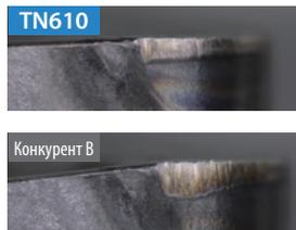
Режимы резания: Врез = 300 м/мин, ар = 1,0 мм, f = 0,2 мм/об., СОЖ, тип CNMG120408; заготовка: 34CrMo4
