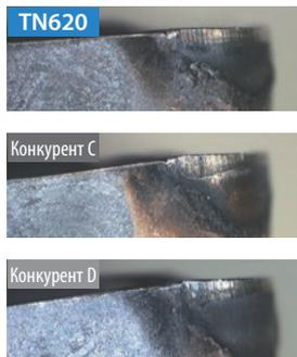
Режимы резания: Врез = 200 м/мин, f = 0,2 мм/об., ар = 1,0 мм, СОЖ, тип CNMG120408; заготовка: 34CrMo4
